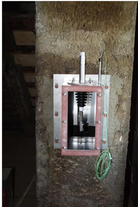
6. Isolator-kammer am Rahmen befestigen. Mittige Ausrichtung der Elektrode prüfen.
