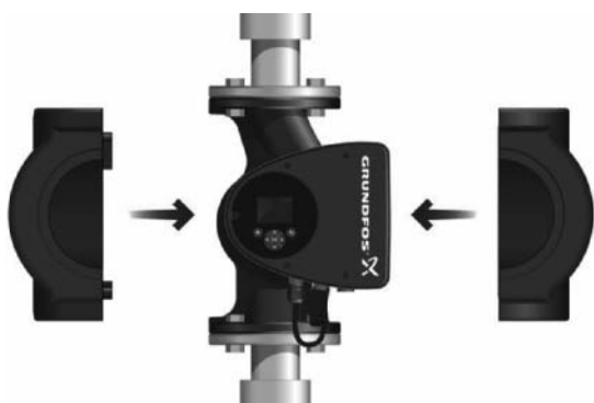
Abb. 49 Anbringen der Dämmschalen an eine MAGNA3
