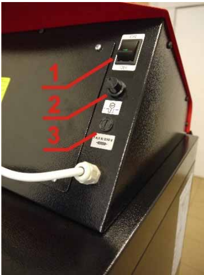
Bild 17. 1 – Hauptschalter, 2 – Havarie Thermostat, 3 – Sicherung (F6,3A)
